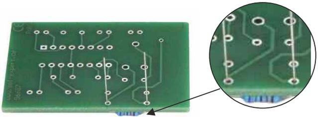
D Souder les fils de connexion de résistance et raccourcir les fils dépassants avec une pince coupante sur env. 1 mm au-dessus du point de soudure
