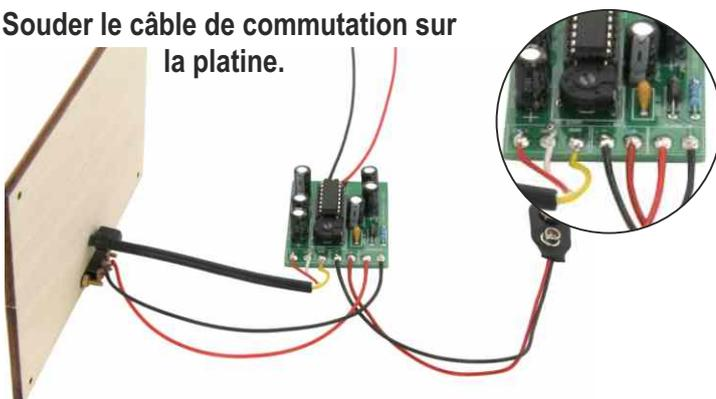
**F** Enfiler le câble de l'enceinte à travers du boîtier de la platine
