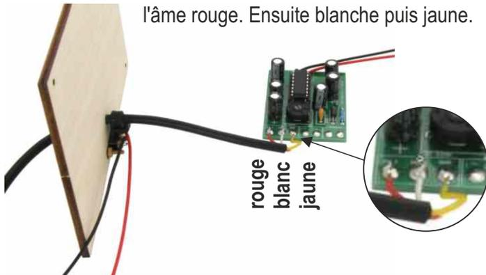
**D** Souder le câble du clip d'accumulateur sur la platine. Veiller à la couleur du câble !
