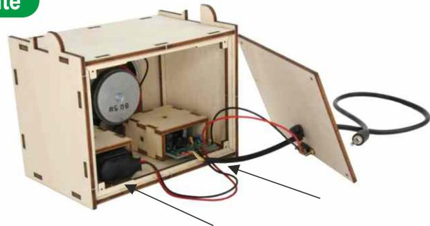
**B** Fermer la partie arrière et revisser au moyen de 4 vis (2 x 10 mm).
