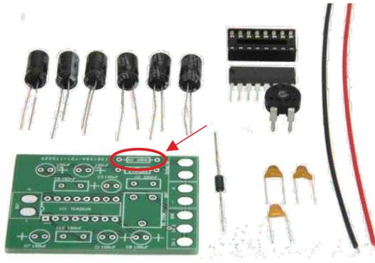
C Faire passer les fils de connexion de résistance à travers la platine (à partir du côté libellé)
